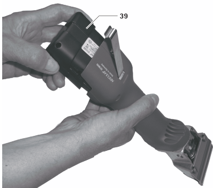
図 2 ➤ リチウムイオンバッテリー 39 をバッテリーロックで f ロックします、図 3 を参照。
